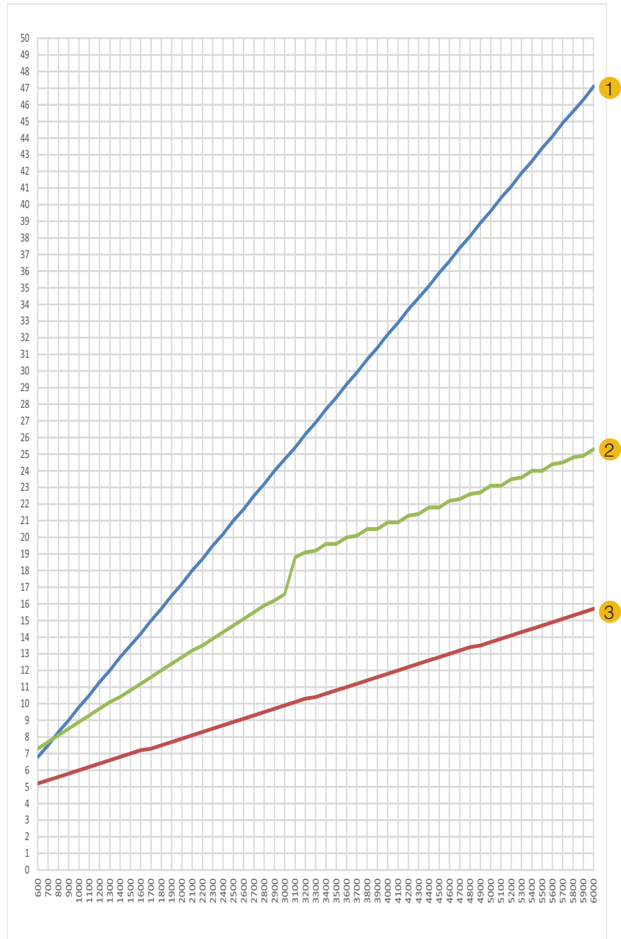
Рисунок 3. Гидравлические характеристики конвекторов Гольфстрим-12В/24В
