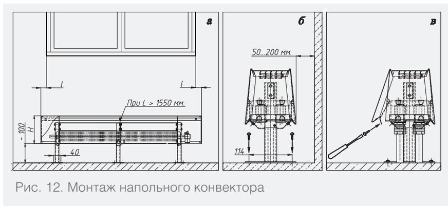
Рис. 12. Монтаж напольного конвектора
