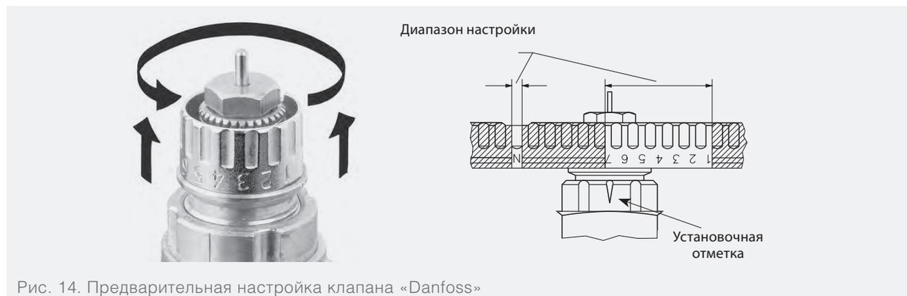
Рис. 14. Предварительная настройка клапана «Danfoss»
