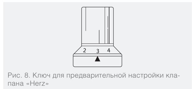
Рис. 8. Ключ для предварительной настройки клапана «Herz»
