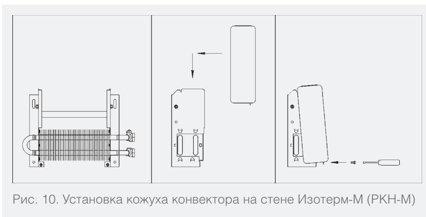
Рис. 10. Установка кожуха конвектора на стене Изотерм-М (PKH-M)
