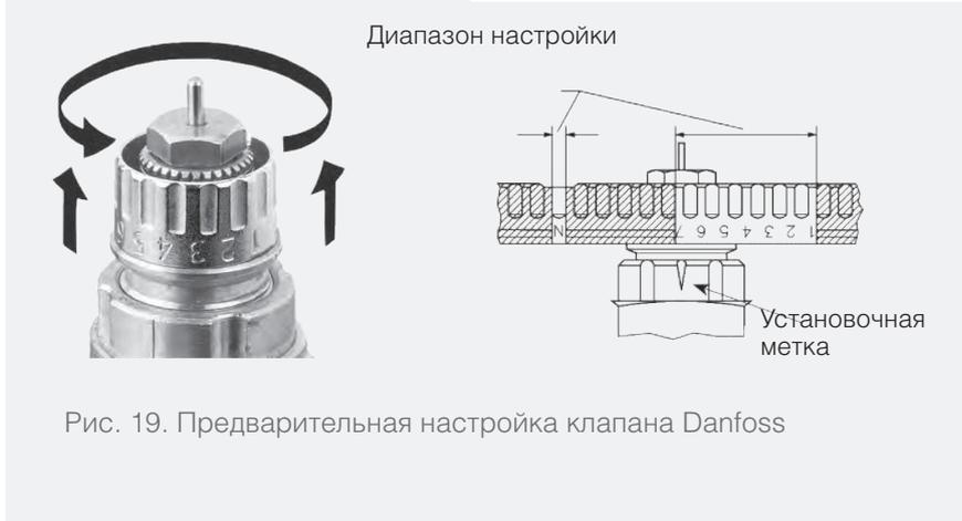
Рис. 19. Предварительная настройка клапана Danfoss
