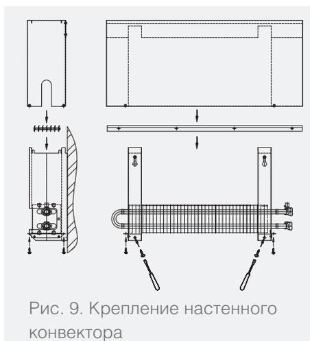
Рис. 9. Крепление настенного конвектора
