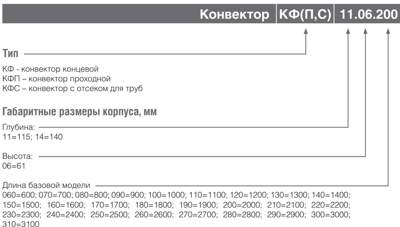
**Таблица 5. Основные технические характеристики фасадных конвекторов типов КФ, КФП**
