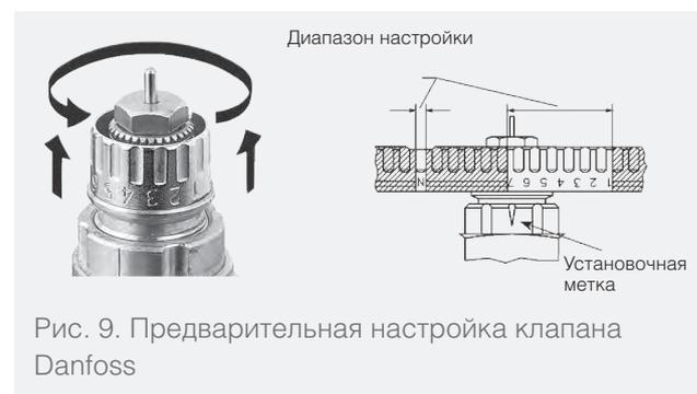
Рис. 9. Предварительная настройка клапана Danfoss
