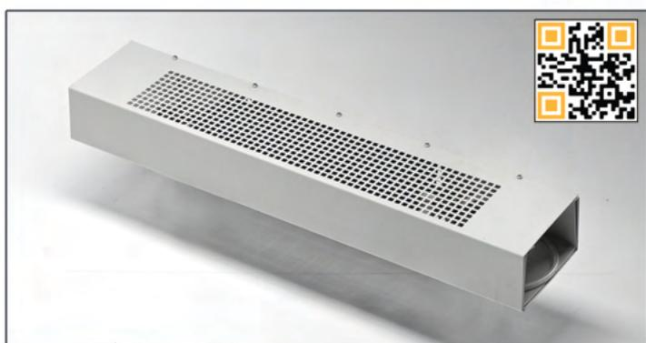
**Фасадный конвектор** - применяется для отопления помещений с многоуровневым витражным остеклением большой площади высотой от 4-х метров. Конвекторы устанавливаются на вертикальные рамы или горизонтальные ригели оконных конструкций в один или несколько ярусов. Возможны варианты исполнения прибора с отсеком для труб и без отсека.
